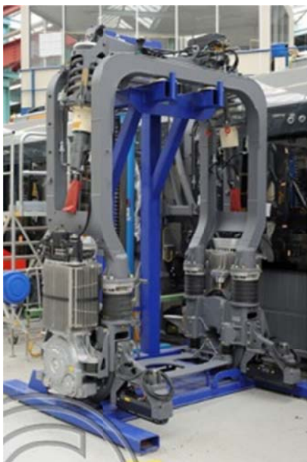
Obrázek 3.14 Podvozek ULF v dílně [5]
