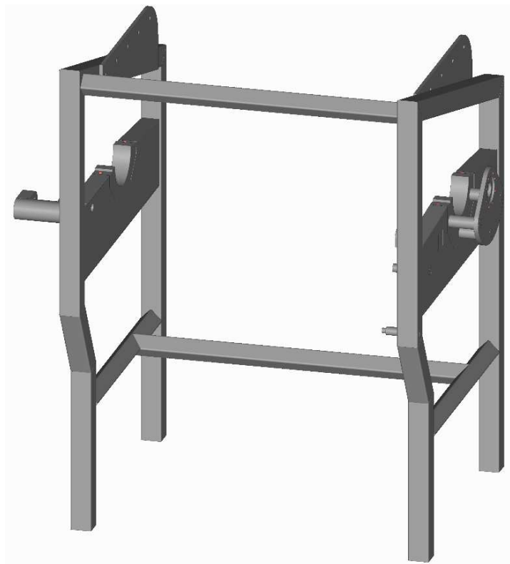
Obr. 43: Rám nové konstrukce
