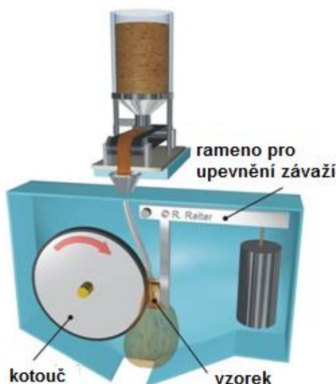
Obrázek 10 - Testovací zařízení dle ASTM G65 [11]
