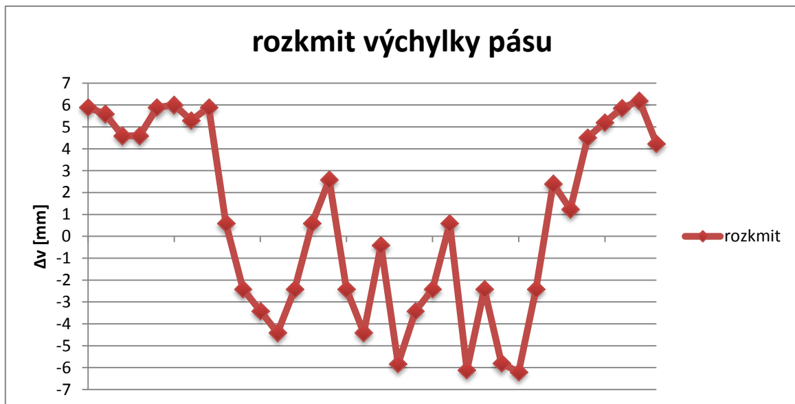
Obr. 52: Grafické znázornění rozkmítu výchylky boku pásu
