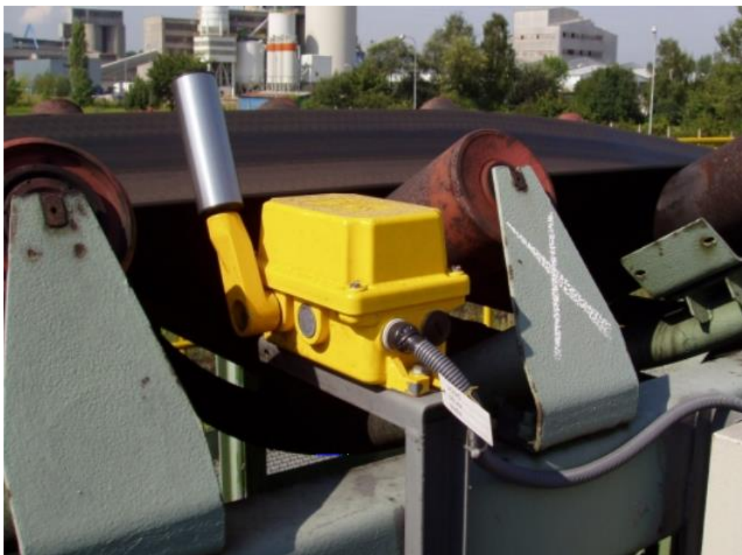
Obr. 12: Spínače typu LHPE-10/2-L50V - ukázka montáže [5]
