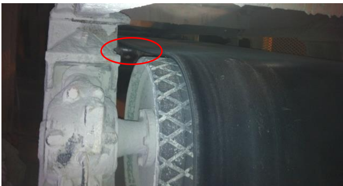
Obr. 13: důsledky vybočení na vratném bubnu [1]
