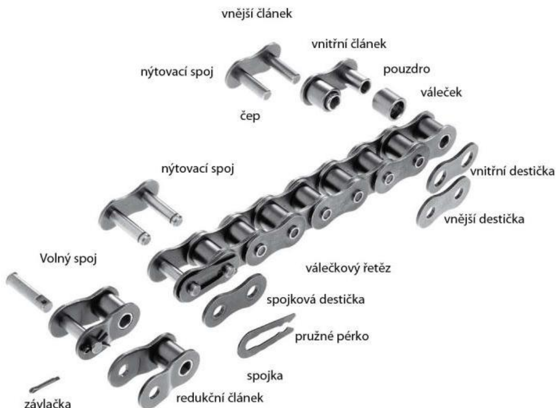
Obr. 13.: Válečkový řetěz - upraveno z [14]
