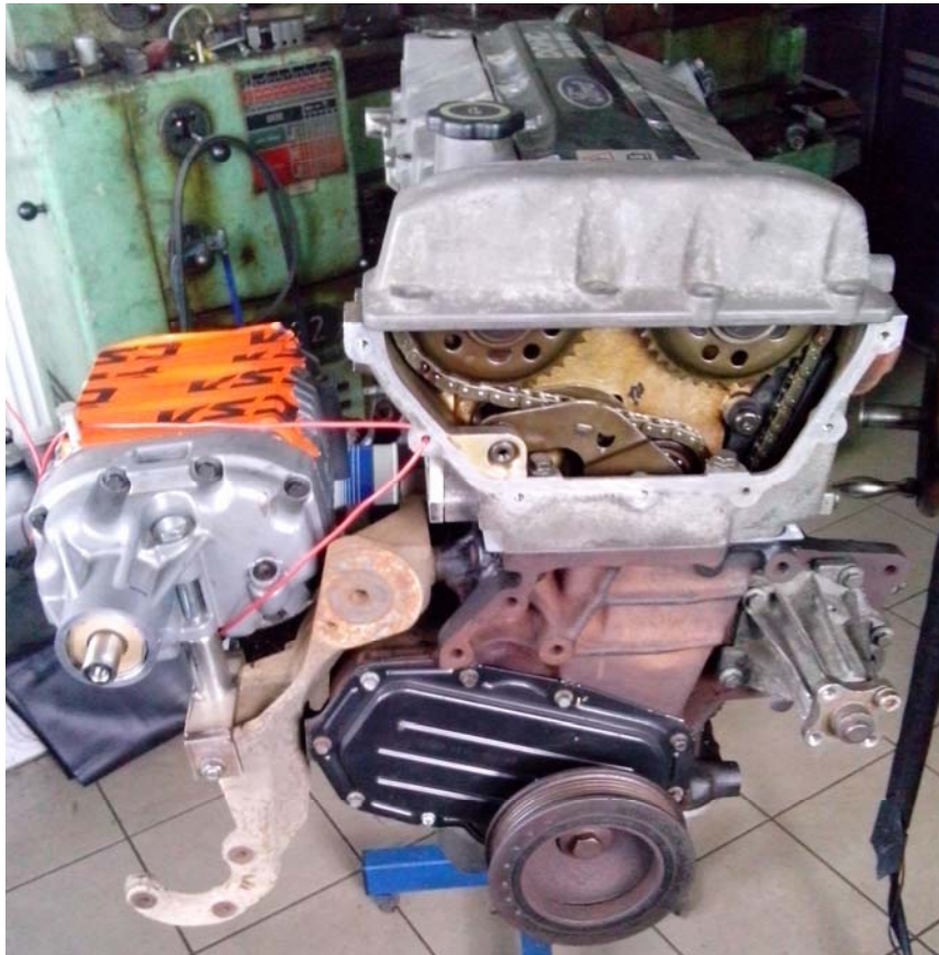
Obr.8.2.3 Optimalizace umístění Eatonu M90.
