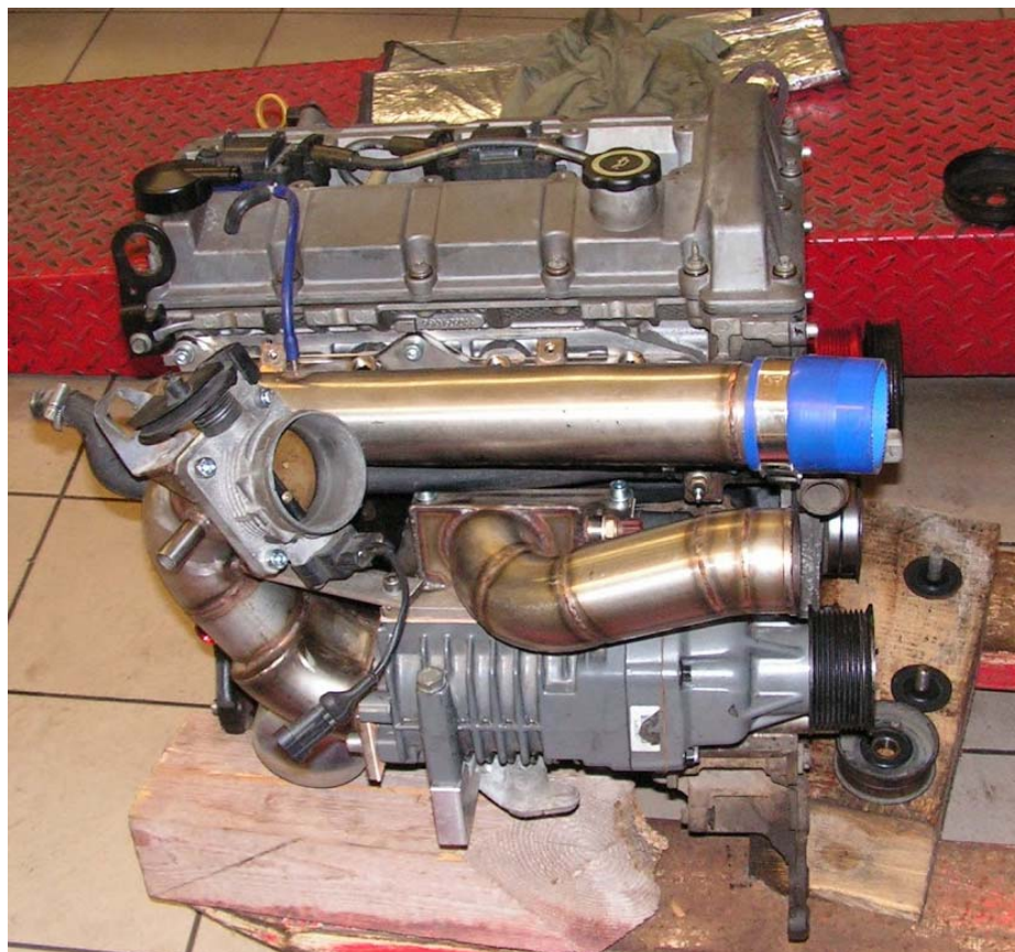
Obr. 8.4.3 Sací strana motoru s Eaton M90 konfigurace ROOTS 2.
