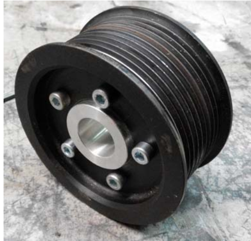
Obr. 8.4.2 Demontovatelná řemenice dmyhadla.
