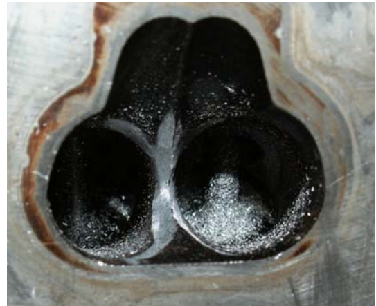
Obr.8.1.3 Sací kanál upravený.
