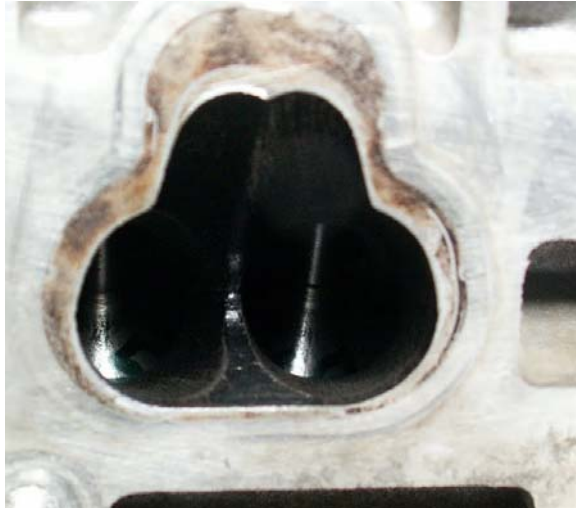
Obr.8.1.2 Sací kanál neupravený.
