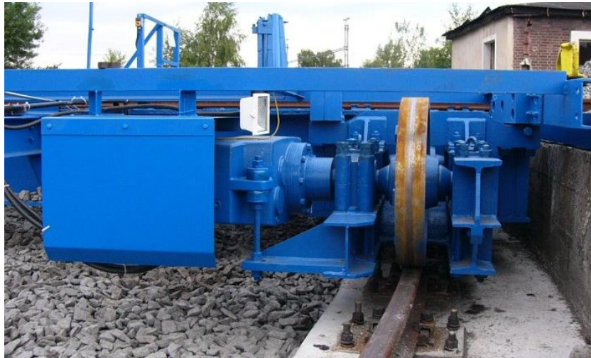
obr. 12.: Hnací jednotka železniční točny lokomotiv, Bohumín, [20]
