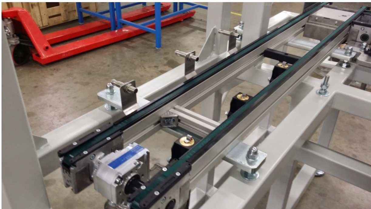
Obrázek 34: Dopravník s indukčními čidly a stopery
