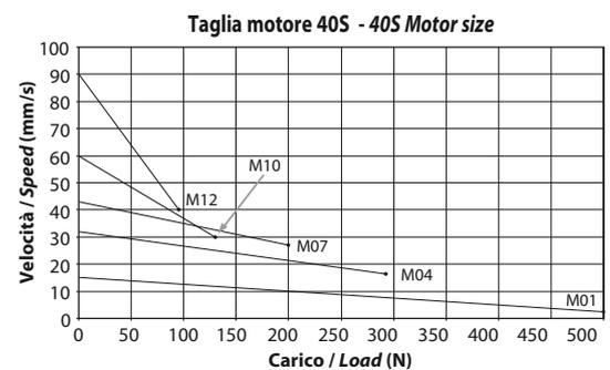
Diagrammi riferiti alla tensione di alimentazione 24Vdc.
