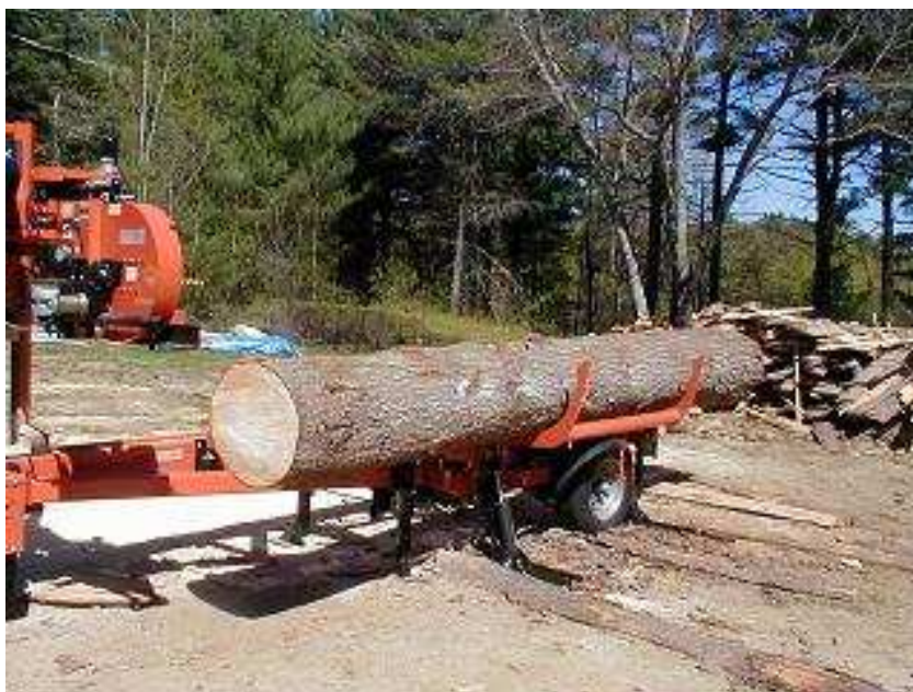
Obr. 1-6 Zvedání kmene na pilu hydraulicky zdroj [30]
