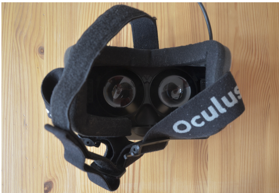
Obrázek 2.3: Pohled skrz čočky zařízení Oculus Rift
