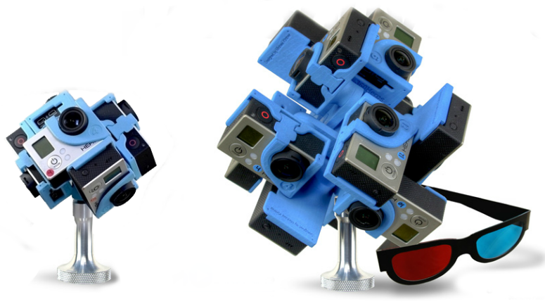
Obrázek 4.4: Klasická a stereoskopická varianta soustavy kamer pro sférické video, převzato z [3]
