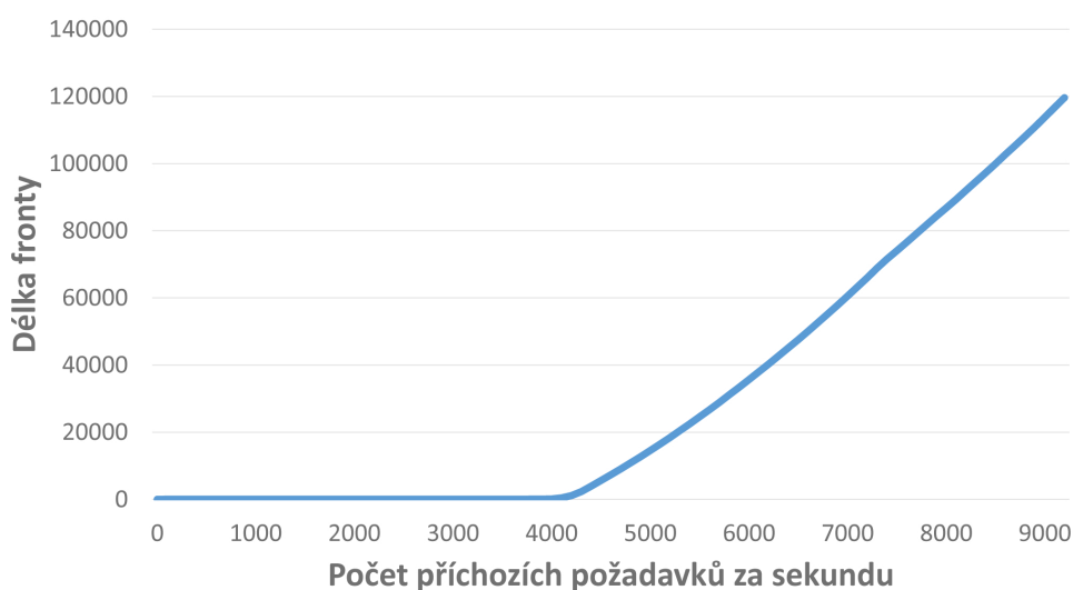
Obrázek 3.8: Graf závislosti délky fronty na počtu příchozích požadavků do systému.
