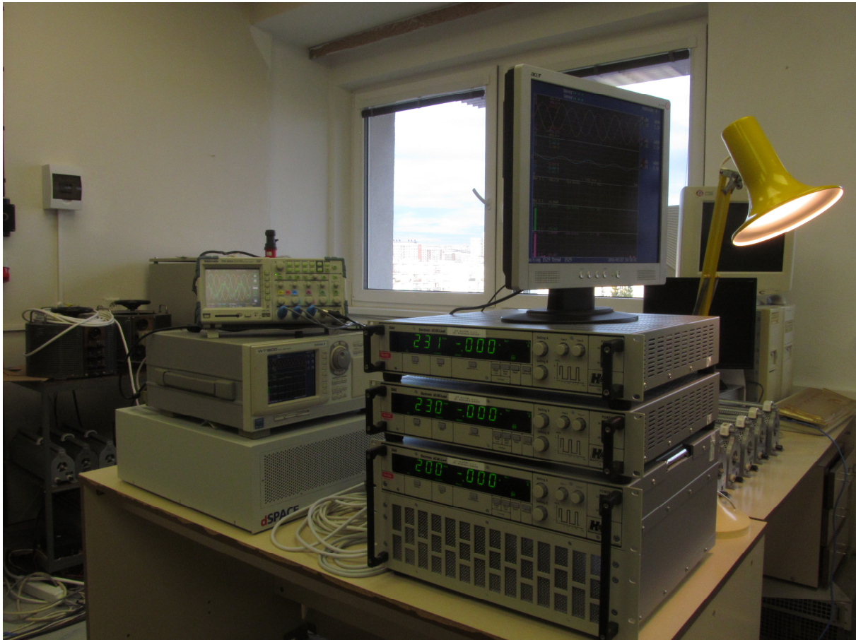
Obr. 5.4 Vlevo: osciloskop TPS2024, analyzátor výkonu Yokogawa WT1600 a dSPACE DS1005; vpravo: programovatelné zátěže ZSAC426 a ZSAC1444
