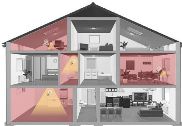
Obr.14 – Umístění žárovek v rodinném domě -technická místnost, WC nebo doplňkový zdroj
