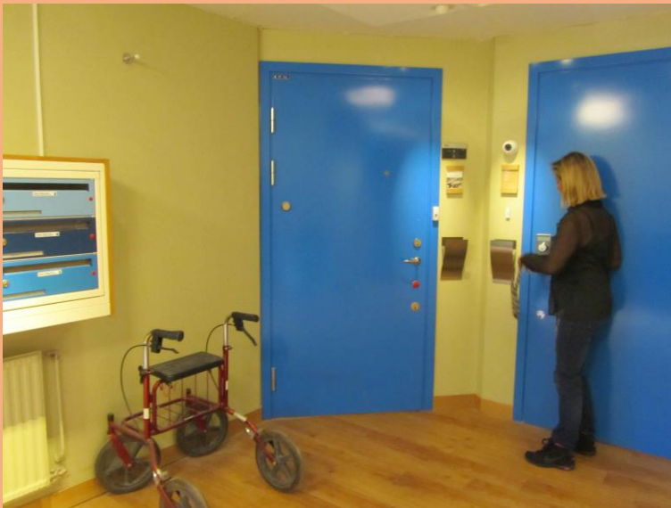
Obr. 8 Barevně zvýrazněné vstupy do jednotlivých bytů a barevně odlišené schránky na dopisy.
