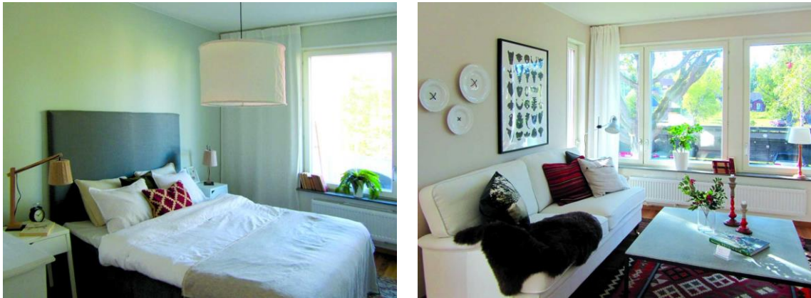
Obr. 2, 3 Nízko osazená okna v ložnici a hlavní obytné místnosti zaručují výhled i pro člověka upoutaného na lůžko nebo invalidní vozík. (Seniorgården Tyresö, Švédsko)
