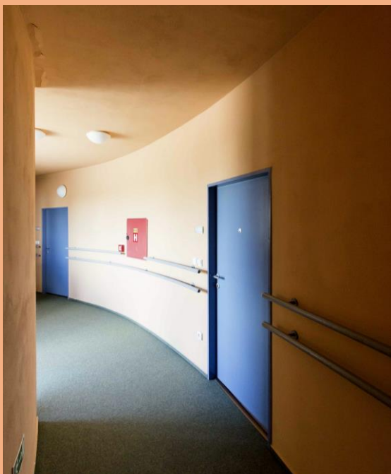
Obr. 59 – 61 Zvlněná chodba vytváří dojem nekonečnosti a pro některé seniory může být matoucí (není jasné, kterým směrem se vydat). (Foto Pavel Lupač 3x)
