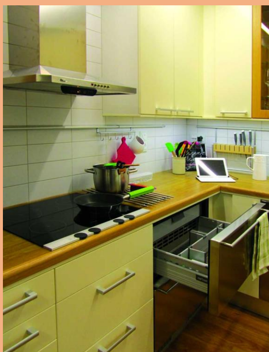
Obr. 11 V kuchyni se nachází celá řada moderních asistivních technologií, jako je hasicí zařízení zabudované přímo v digestoři, nebo indukční varná deska ovládaná mechanicky pomocí kulatých prvků (nikoli dotykově). Výsuvná myčka nádobí umožňuje jeho snadné skládání.
