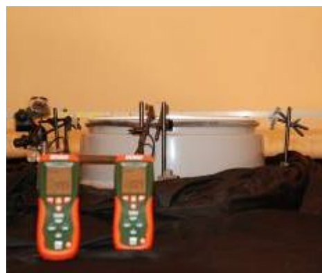
Obrázek 17: Luxmetry Extech č. 14 a č. 15 na měřícím stole, včetně límce světlovodu vodící lišty pro měření zpětného odrazu
