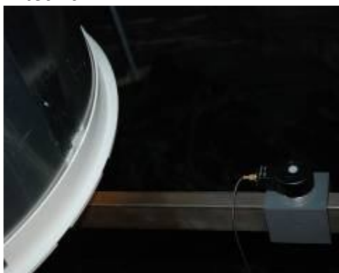
Obrázek 10: Čidlo luxmetru Brüel na vodícím kříži
