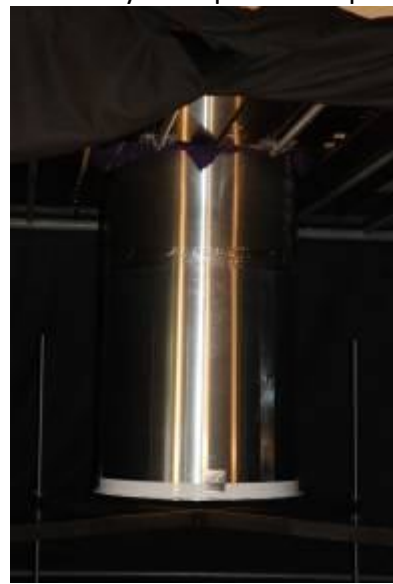
Obrázek 7: Pohled na světlovod ze spodu měřicího stolu a utěsnění průsvitů
