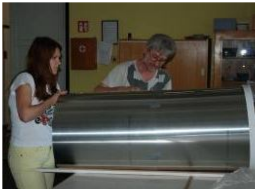
Obrázek 1: Montáž vzorku světlovodu č. 1 z jednotlivých segmentů
