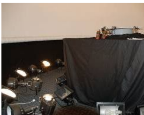
Obrázek 16: Vzorek světlovodu č. 2 pod umělou oblohou, včetně nasvícených reflektorů
