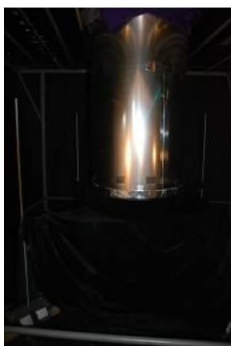
Obrázek 18: Tubus světlovodu vzorku č. 2 pod měřícím stolem společně s nasazeným difuzorem
