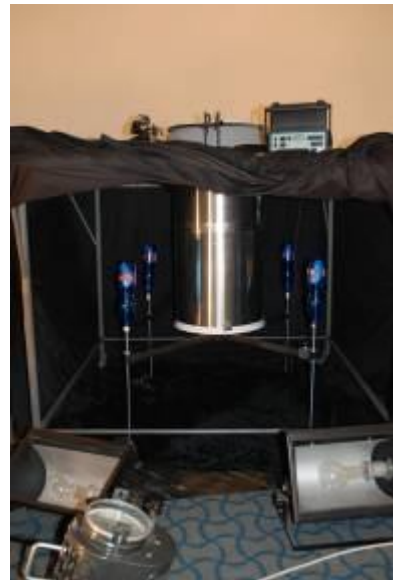
Obrázek 5: Usazení vzorku světlovodu včetně pohledu na reflektory a bezpečnostní prvky
