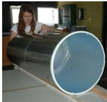
Obrázek 2: Montáž vzorku světlovodu č. 1 pomocí hliníkové fólie
