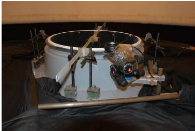
Obrázek 23: Měření zpětného odrazu pomocí dvou čidel luxmetrů Extech č. 14 (vstupující osvětlenost) a č.15 (zpětný odraz)
