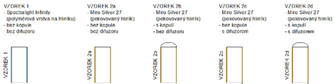
Obrázek 14: Schematické obrázky testovaných vzorků světlovodů o průměru 530 mm a délky 1 170 mm
