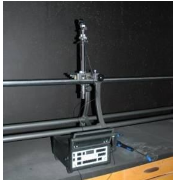
Obrázek 20: Senzor Precision Photometer Bruel Kjaer 1105 na fotometrické lavici při kalibraci
