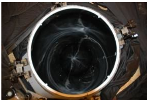
Obrázek 25: Pohled do světlovodu, na spodním líci rozprostřen samet
