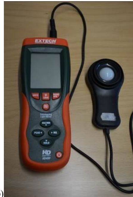
Obrázek 18: a) Luxmetr Precision Photometer Bruel-Kjaer 1105, b) Luxmetr Extech 450 č. 14
