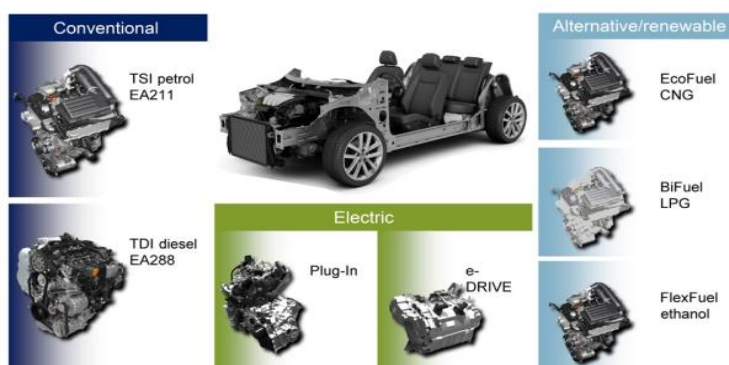
Obr. 0-5 Skupina pohonných systémů pro platformu MQB [6]
