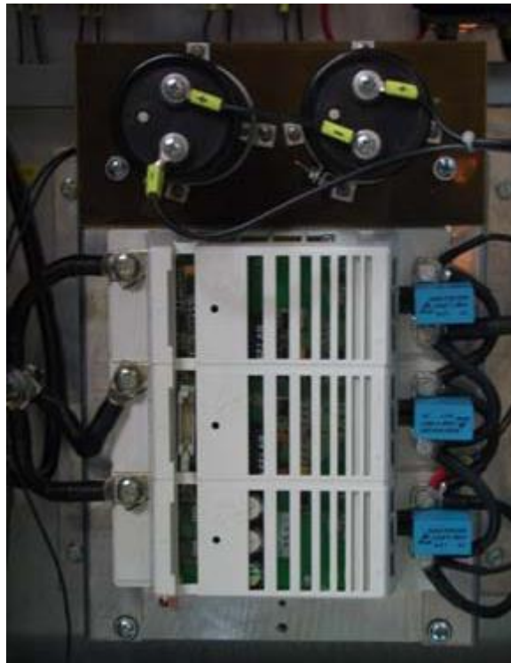
Obr. 9-3 Výkonový modul Semikron (28 x 22 x 16 cm, 10 kg)
