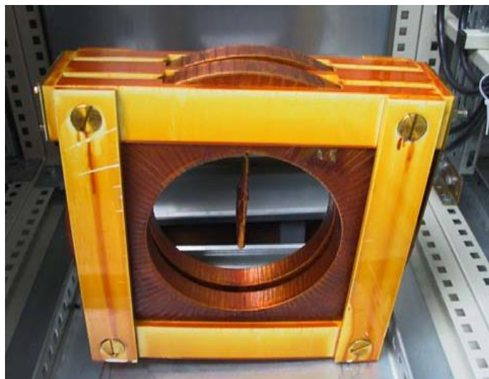
Obr. A-3 Vzduchová tlumivka 1 mH / 100 A, 35x35x11 cm, 33 kg
