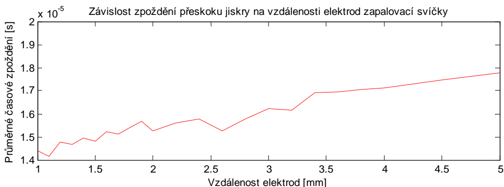
Obr. 18. Závislost průměrného zpoždění přeskočení devadesáti jisker na vzdálenosti elektrod svíčky.
