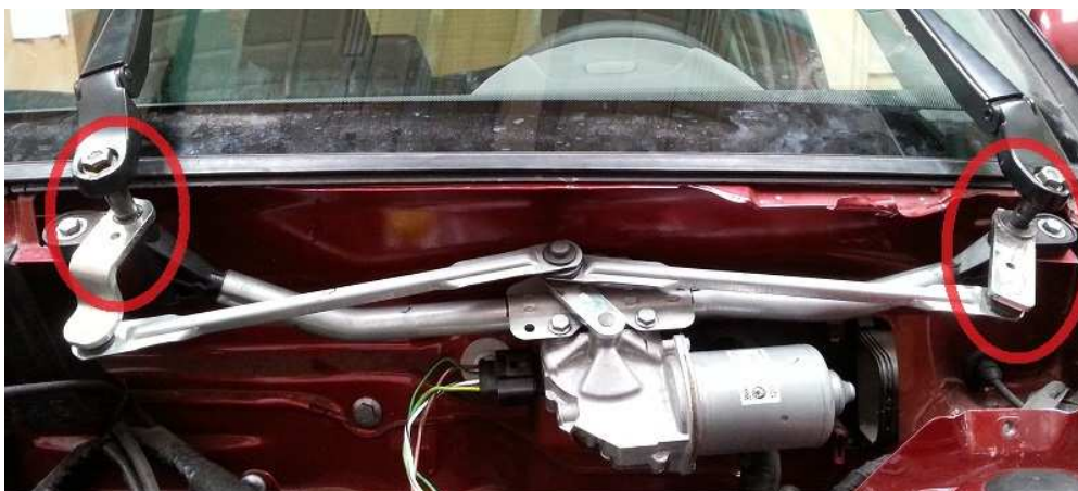
Obr. 35. Místo výskytu nejčastější poruchy stěračů – zadírání táhel.
