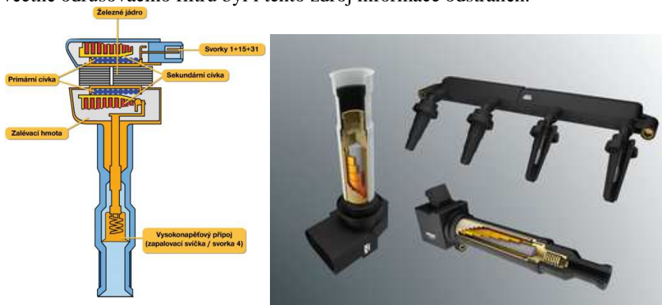
Obr. 2. Zobrazení jednojiskrových zapalovacích cívek (SIC – Single Ignition Coil) [18].
