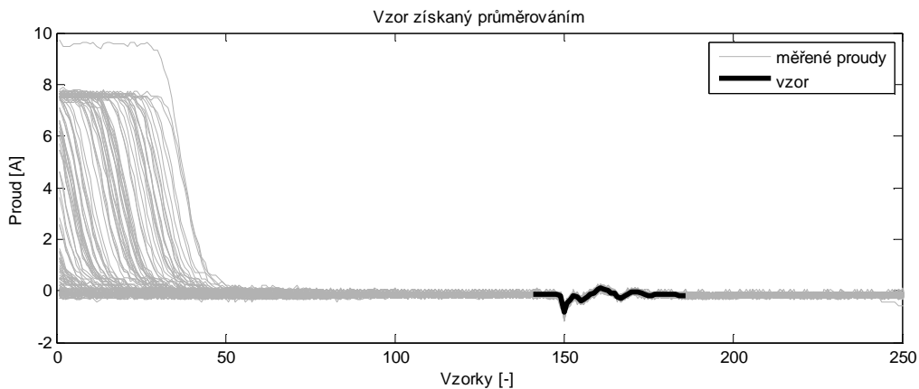
Obr. 43. Vzor méně častého projevu poruchy vytvořený průměrováním z tisíce náměrů.
