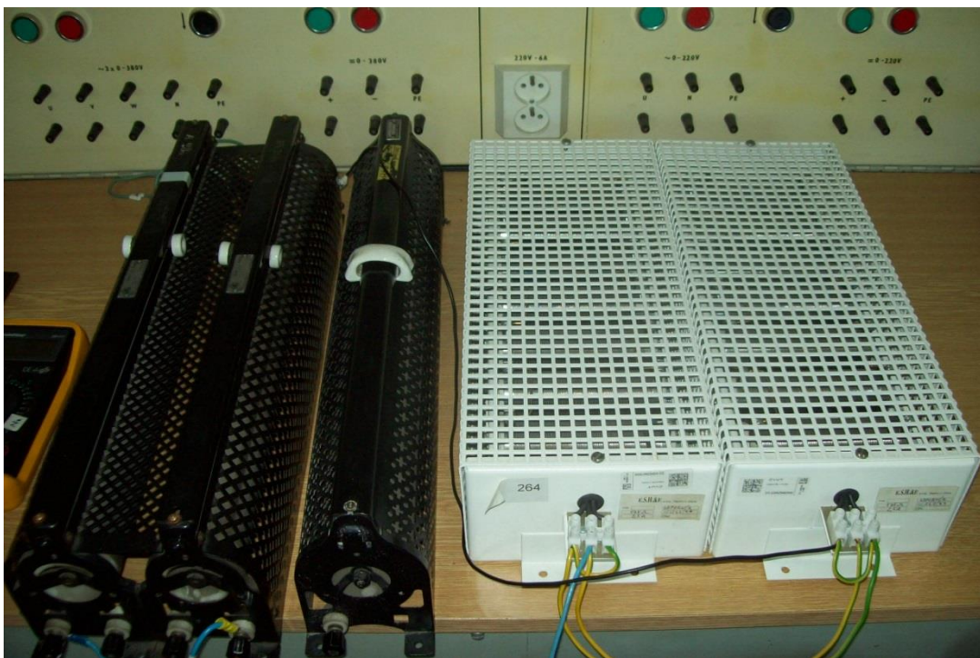
Obr. 4.2.2. Činné odpory zátěže R_z , vlevo regulační drátový odporník a vpravo pevný drátový odporník
