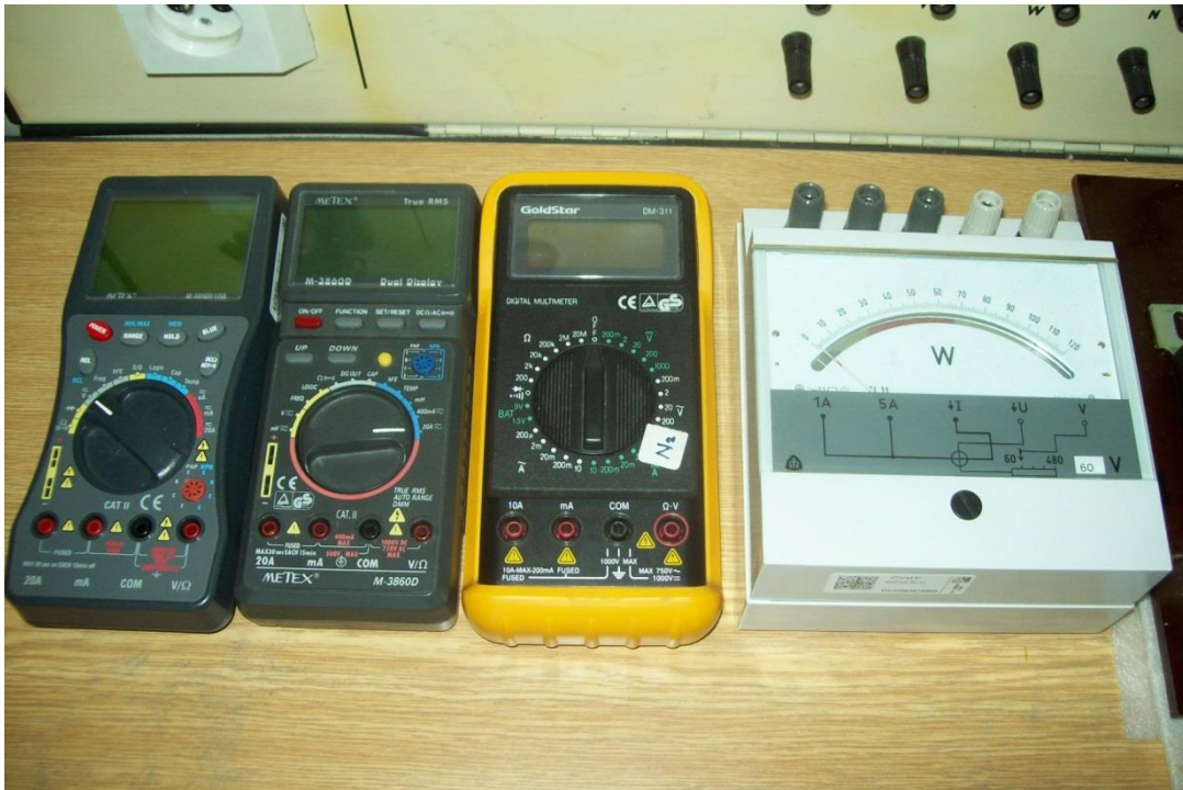
Obr. 4.2.1 Měřicí přístroje, zleva U_1 , I_1 , U_2 , P
