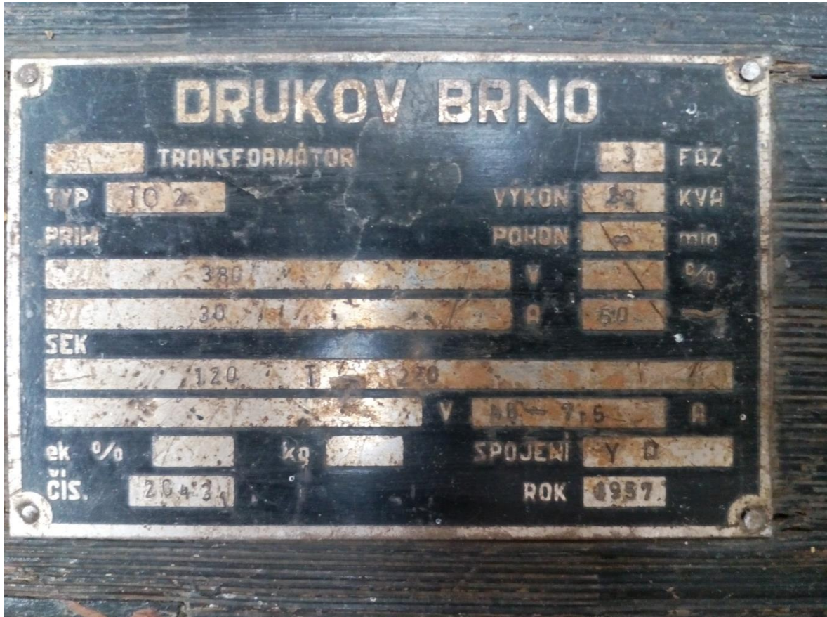
Příloha č. 1 štítek transformátoru 20 kVA
