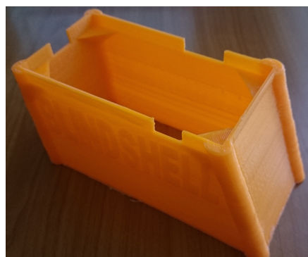
Obrázek 6.4. Výsledek 3D tisku stojánku na Samsung Galaxy Core 2
