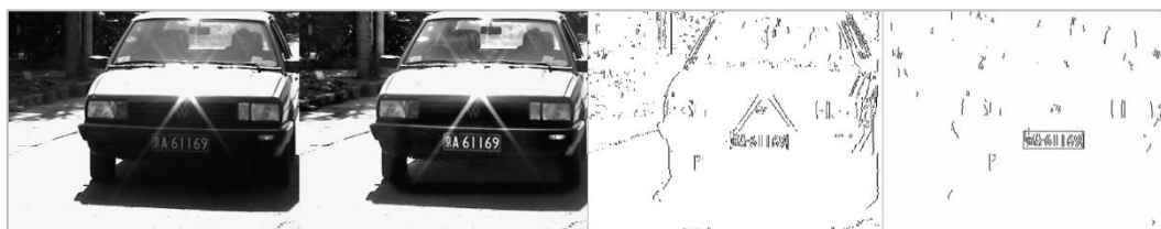
Obr. 34: Zásadní kroky metody pro detekci RZ navrhované v [15]
