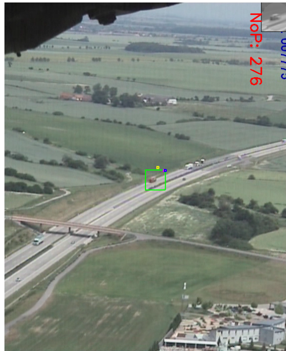
Obrázek 5: Grafické uživatelské rozhraní se zobrazením sledovaného objektu. Zelená barva čtverce odpovídá stavu automatu 1 a 2, žlutá by odpovídala stavu 6, fialová 3 a červená stavům 4 a 5.
