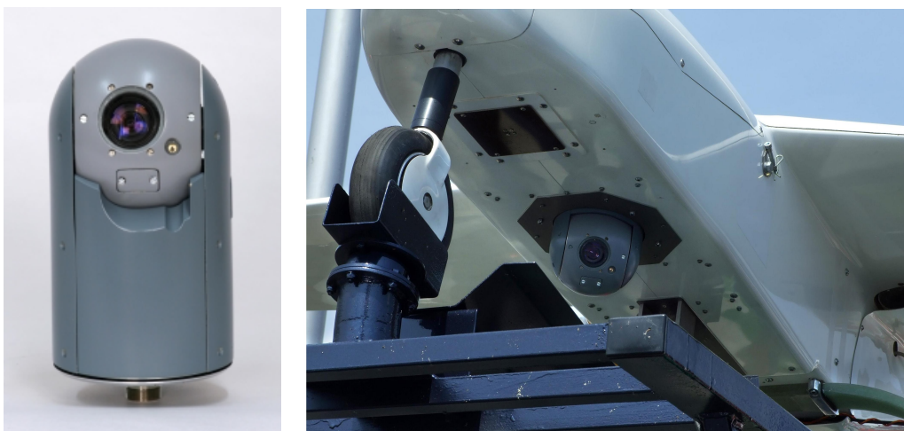
Obrázek 1: Použitá kamerová hlavička a její instalace na podvozku letounu MANTA
