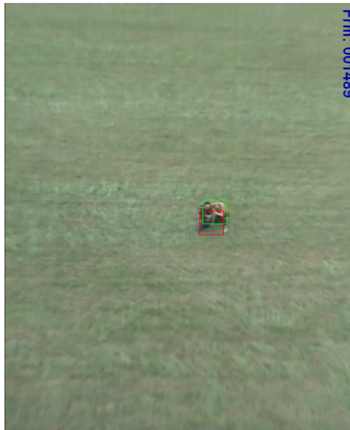
Obrázek 6: Volba sledovaného objektu pomocí funkce goodFeaturesToTrack , červený čtverec představuje volbu operátora a zelený čtverec upravené souřadnice objektu.
