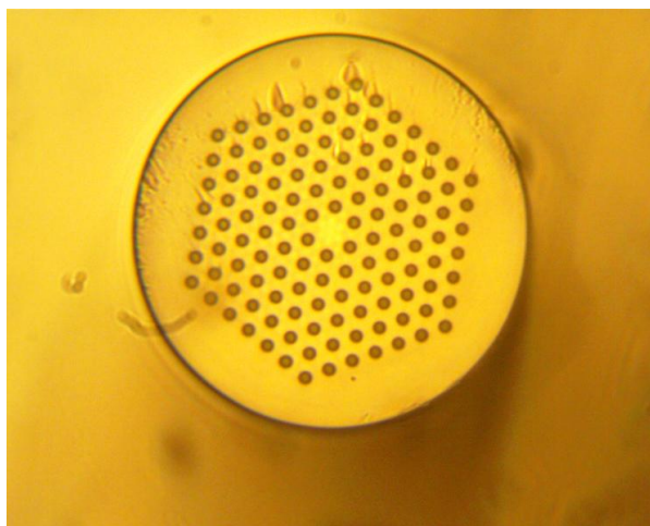
Obr. 37 Řez měřeným vláknem typu Endlessly Single Mode 12B
