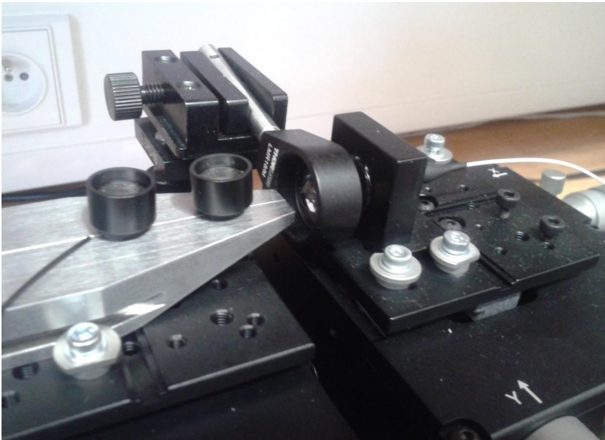
Obr. 30 Detail navazování signálu do SMF vlákna
