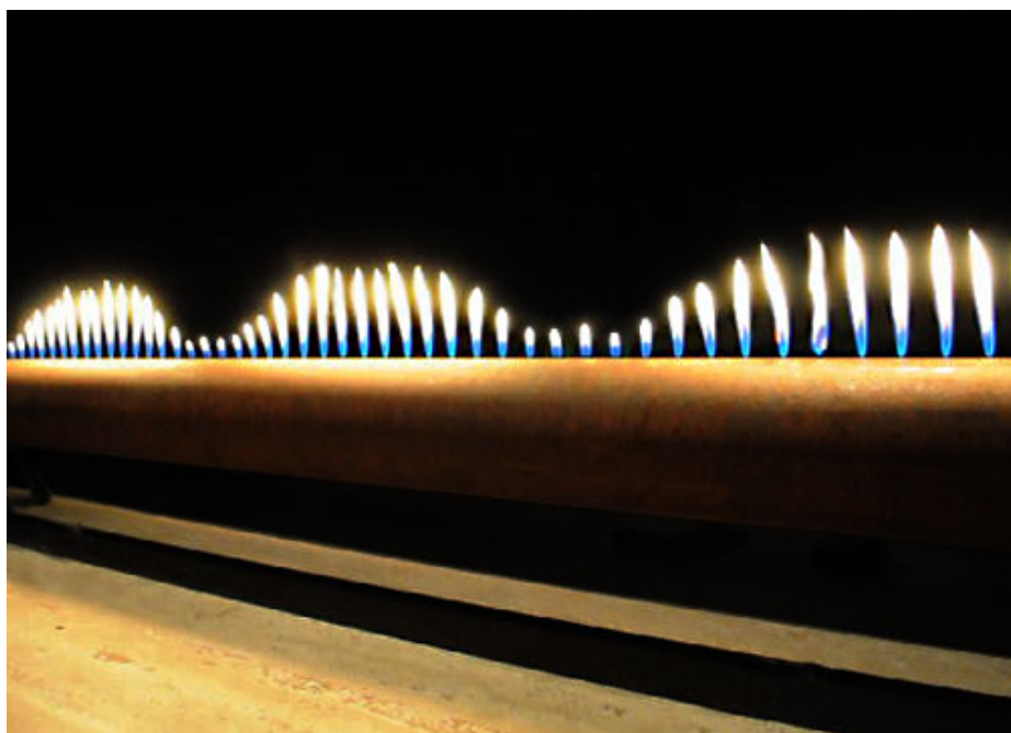
Obrázek 2.2: Využití Rubenovy trubice ke znázornění frekvence přehrávaného tónu
