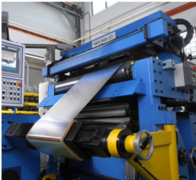
Obrázek 9: Navíjení foliového vinutí
