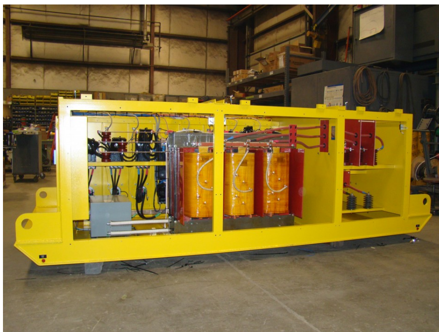
Obrázek 15: Příklad vnitřního provedení důlního transformátoru
