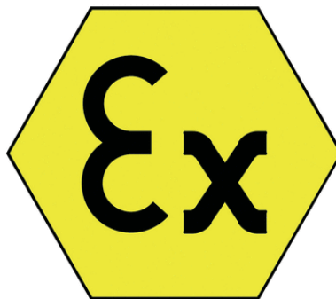
Obrázek 10: Značka zařízení určených do prostředí s nebezpečím výbuchu
