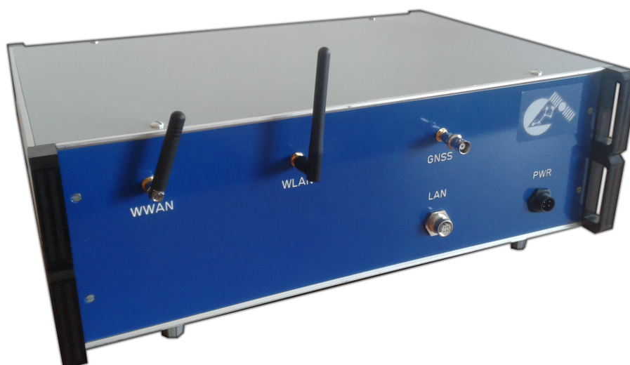
Obrázek 4.1.: Prototyp drážního lokátoru
