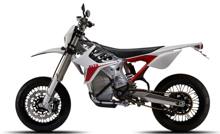
Obrázek 1. REDSHIFT SM s elektrickým pohonem, výkonem 40 HP, kapacitou akumulátorů 5,2 kWh, dojezdovou vzdáleností 80 km, maximální rychlostí 135 km/h a váhou 120 kg [2]
