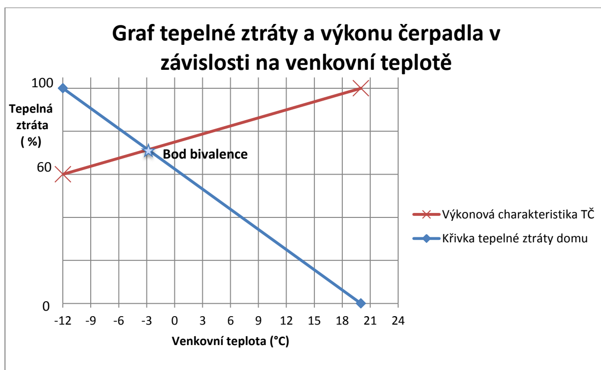
Graf 3 – Graf tepelné ztráty a výkonu čerpadla v závislosti na venkovní teplotě [3]
