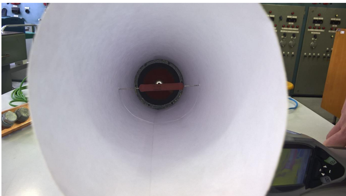
Obrázek 13 - Umístění měřeného objektu v trubici aerodynamického tunelu
