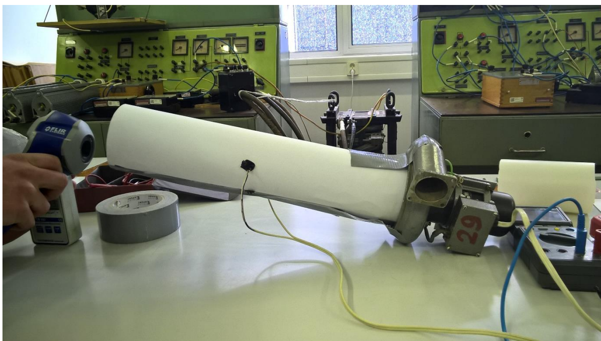
Obrázek 12 - Kontrukce nasávání vzduchu, pro imitování větru
