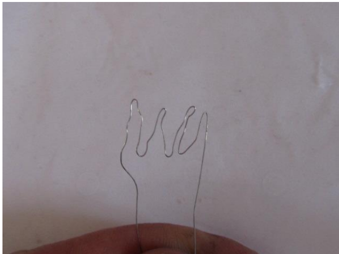
Obrázek 16 - Odporový drátek, pro simulování koroze šroubového spoje
