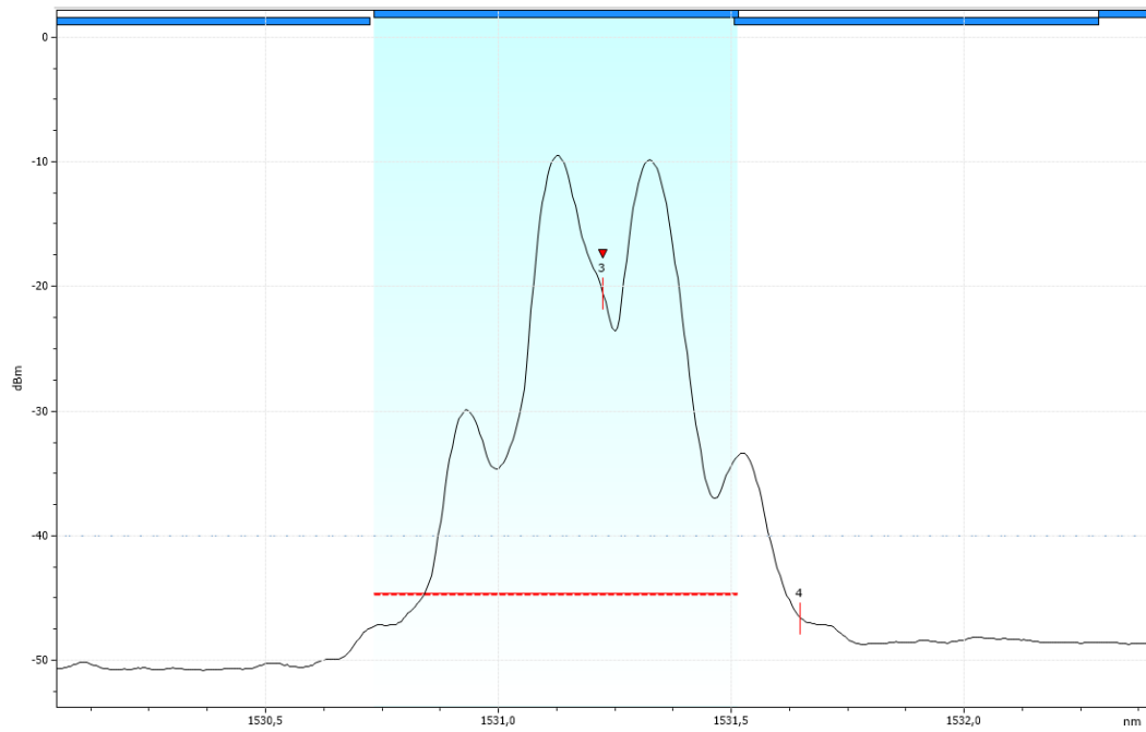
Obrázek 4.3: Kanálový rozestup 25 GHz
