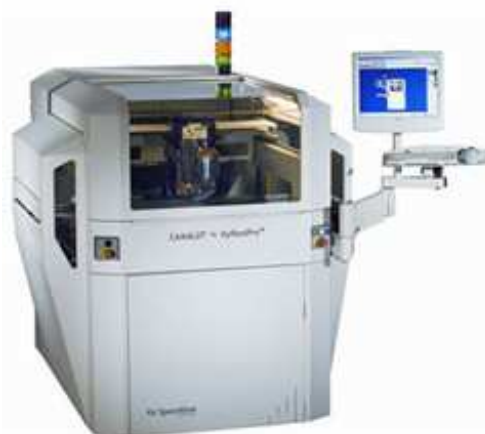
Obr č.5 (vlevo) ruční dispenzní nanášeč, (vpravo) automatizovaný dispenzní nanášeč, (převzato z [5])
