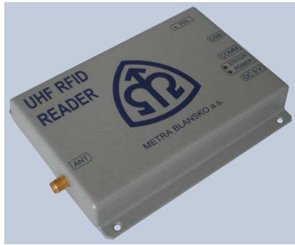
Obr. 4. Čtečka Metra Blansko. Na pravé straně jsou umístěny USB konektor a konektor pro napájecí zdroj, na levé straně anténní konektor [5].
