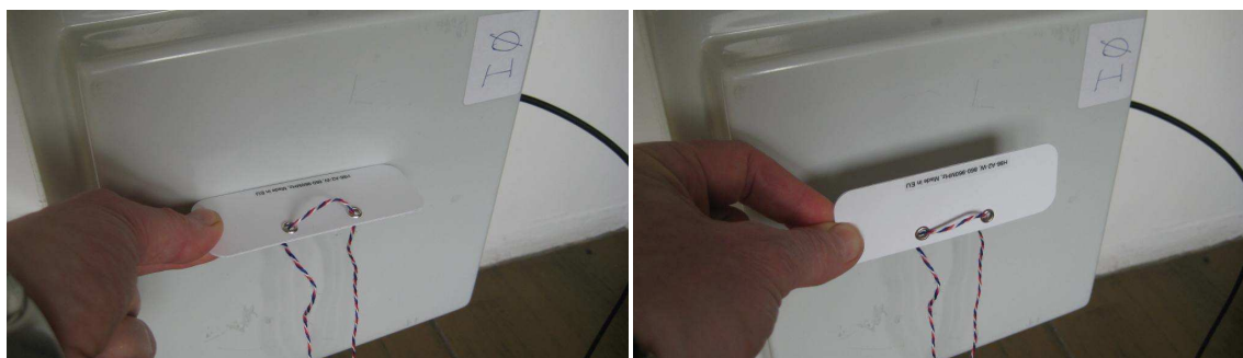
Obr. 22. Měřené orientace tagů, vlevo kolmá, vpravo rovnoběžná orientace k ploše antény [autor].
