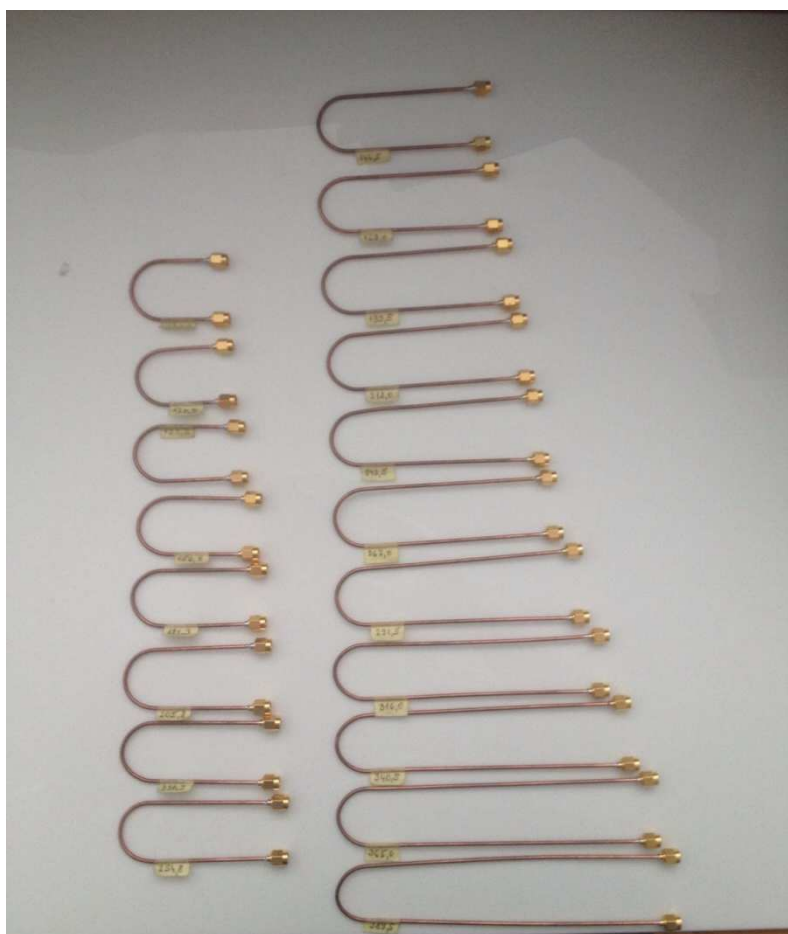
Obr. 5.42 Měřicí sady vedení pro vytvoření dvou vln s různým úhlem dopadu na rozhraní.
