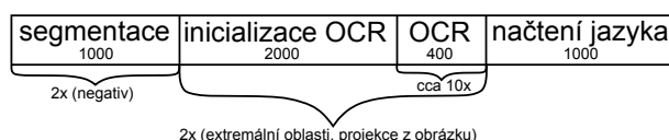
Obrázek 4.1. Orietační časy (v milisekundách) trvání kritických fází zpracování na telefonu HTC Desire X pro obrázek 800 × 600px
