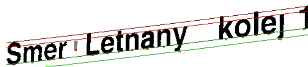
Obrázek 2.8. Oblasti použité k sestavení prototypu (černé a šedivé). Červenozelené linky jsou nalezený prototyp. Šedivá oblast (svíslá pomlčka) po sestavení prototypu vyloučena, protože nesedí na linkách. Body použité k prokládání směrnice jsou červené čtverečky.
