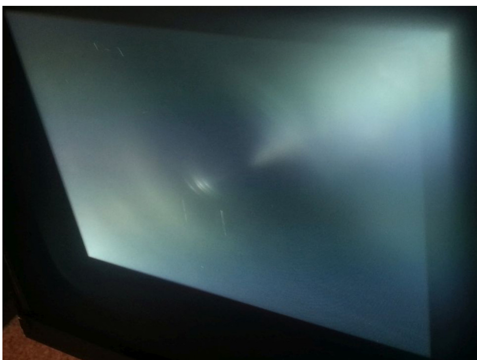
Obr. 17: Ukázka rozdvojení obrazu při použití Fresnelovy čočky
