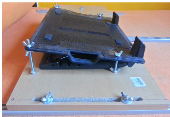
Obr. 66: Ukázka podložky se šrouby pro nastavení výšky a sklonu, dole drážka se šrouby pro posun
