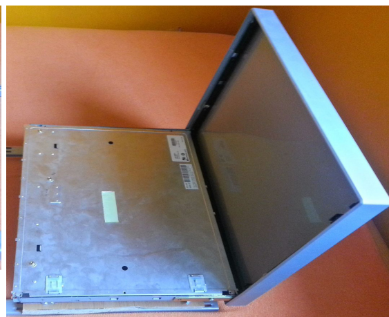
Obr. 67: Připevněný panel s kryty
