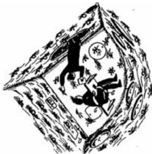
Obrázek 26. Interiér habitatu s mikrogravitací dle návrhu Hermana Potočnicka z přelomu 19. a 20. století - Na obrázku vidíme jednu osobu přichycenou pásky ke stolu tak, aby mohla stůl použít obvyklým způsobem. Druhá osoba "proplouvá" kruhovými dveřmi. Celý interiér je polstrován (Noordnung, 1995, str. 81).
