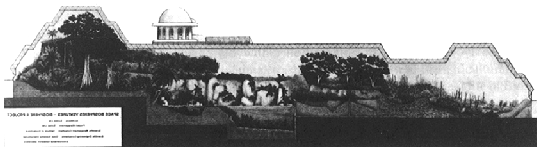
Obrázek 22. Podélný řez Biosphere II (MacElroy, Averner, Tibbitts, Bugbee, Horneck, & Dunlop, 1992, str. 213).
