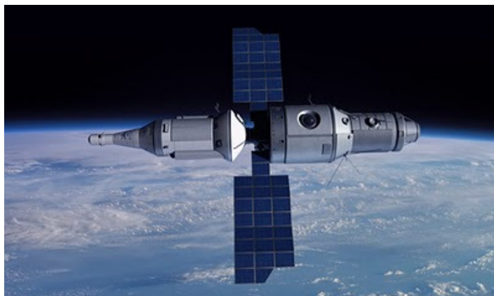
Obrázek 89. Vizualizace hotelu od společnosti Excalibur Almaz na nízké orbitě Země. Pravý modul představuje renovovanou stanicí Saljut a levý kosmickou loď TKS s přistávacím modulem (Rocketeer, 2008).
