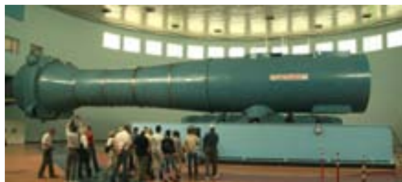
Obrázek 31. Největší centrifuga na světě v Moskevském Hvězdném městečku je schopna simulovat ve volitelných směrech zrychlení přes 30 G.
