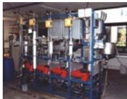
Obrázek 18. Schéma principu filtrace vody v recyklačním systému provozovaném na stanici Concordia, popis filtrů a fotografie filtračního systému (ESA, 2006).
