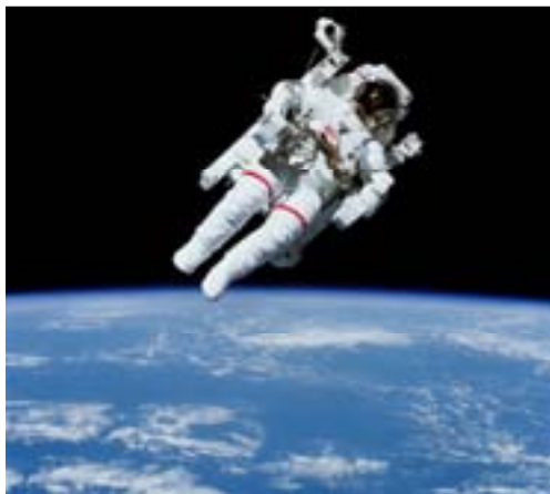
Obrázek 7. Astronaut Bruce McCandless vybaven skafandrem s přenosnou jednotkou podpory života a osobní manévrovací jednotkou ( jetpack ) volně se pohybující ve vakuu na oběžné dráze Země (1984), (Greene, 2010).
