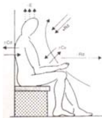
Obrázek 2. Tepelné výměny lidského těla s okolním prostředím. M= tvorba tepla metabolismem, Rd= sálání, Cd=vedení, Cv= proudění, E= odpařování (Szokolay, 2004, stránky 16,17).
