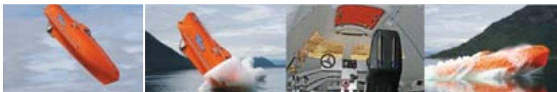
Obrázek 69. Záchranný člun od firmy Schat-Harding je uzpůsoben dopadu z výšky až 50 metrů (Schat-Harding, 2010).
