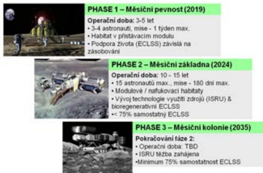
Obrázek 103. Schéma předpokládaného osídlení měsíce člověkem s potřebnými systémy.
