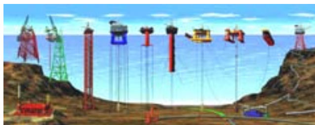
Obrázek 62. Typy ropných plošin a infrastruktura (NOAA, 2008).
