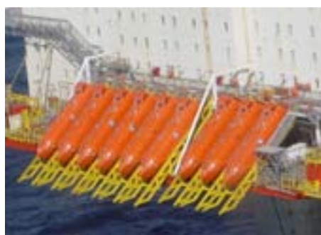
Obrázek 68. Únikové platformy pro všechny obyvatele plošiny připevněné ve speciálních příhradových rámech na boku horní paluby (Norsafe, 2010).
