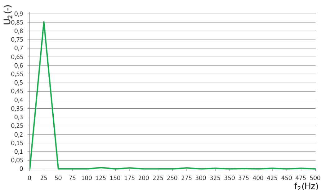
Obr. 7.2: Simulace teoretického maxima výstupního napětí maticového měniče pro 25 Hz
