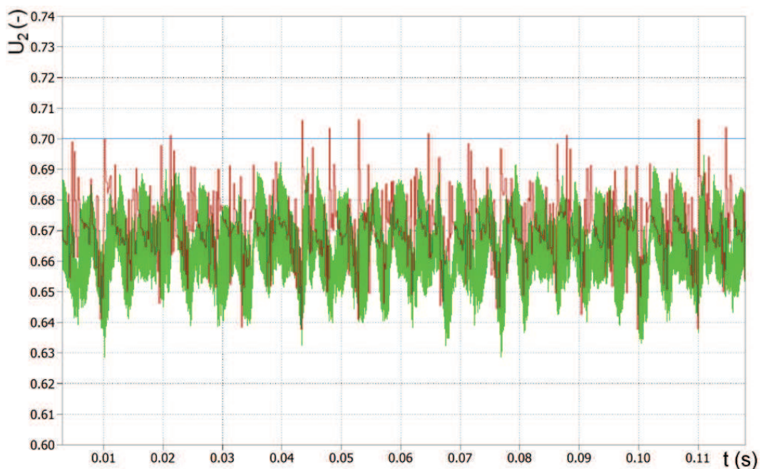
Obr. 7.5: Porovnání zadaného (modrá), měřeného (zelená) a estimovaného (červená) výstupního napětí bez kompenzace komutace - simulace
