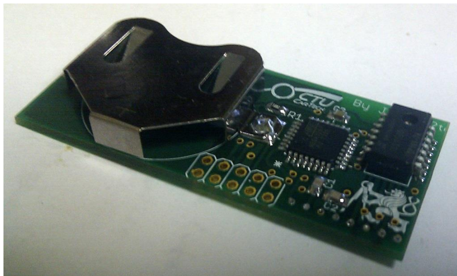
Obr. 4.8 Plošný spoj se senzorem a anténou na spodní části
