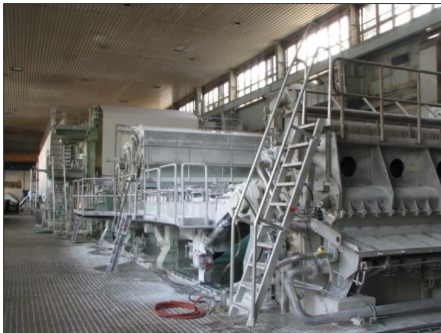
Obr. 6.2 Papírenský stroj – začátek, nátok látky na síto.
