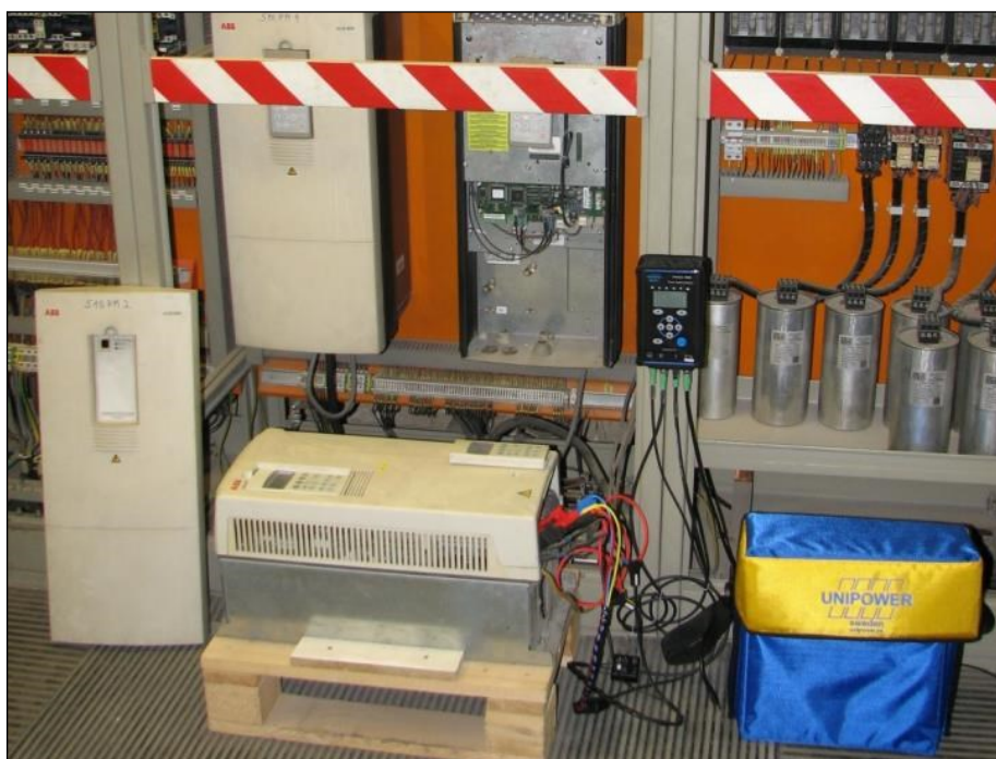
Obr. 8.5 Měření vstupních veličin měniče kmitočtu přenosným analyzátelem.
