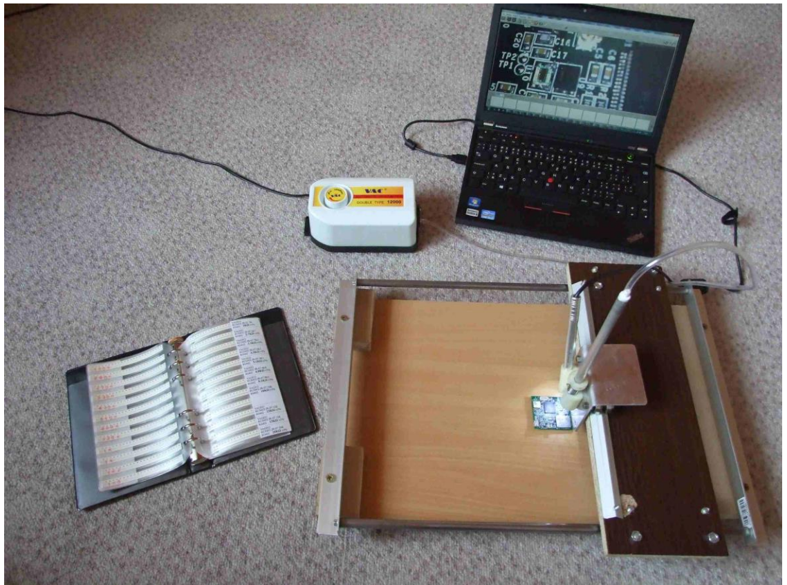
Obr.C.4: Fotografie osazování DPS pomocí manipulátoru
