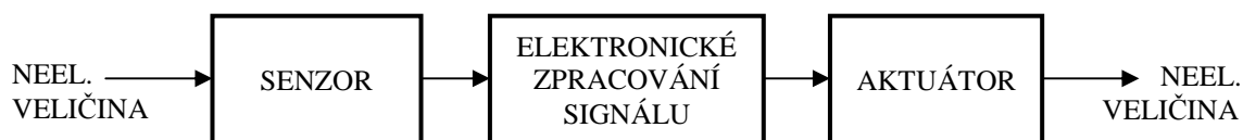
Obr. 1.: Základní struktura systému elektronicky zpracovávajícího neelektrickou veličinu a působící na neelektrickou veličinu.
