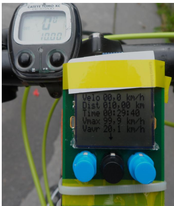
Obrázek 33: Testování cyklopočítače - vzdálenost
