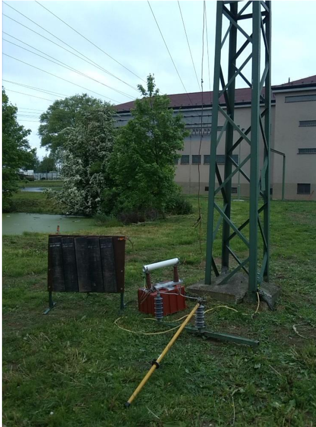
Obr. 4.14 – Venkovní pracoviště (zleva odpor, pojistka, jiskřiště)
