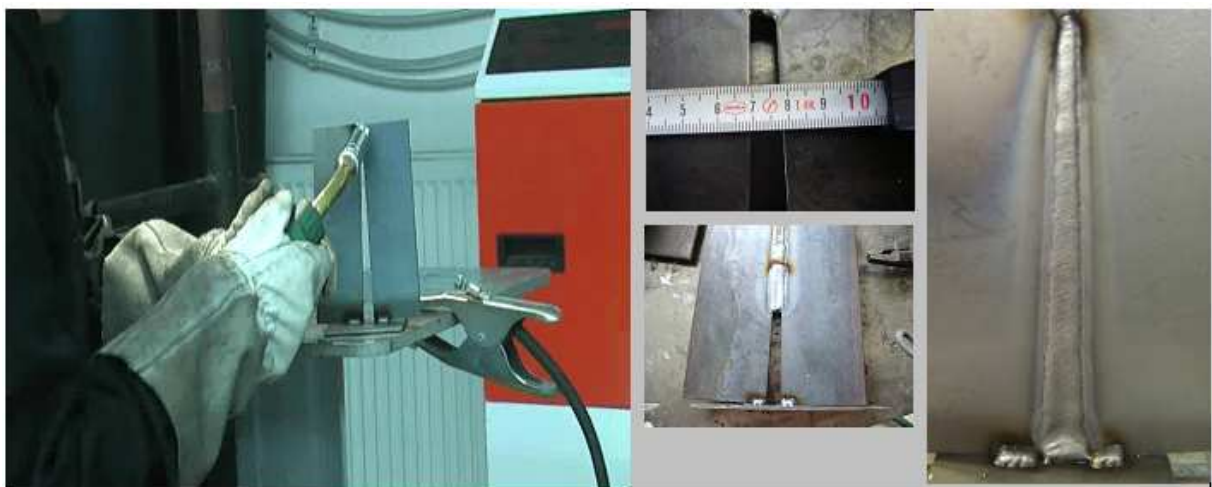
Obrázek 8.10 Na snímku je znázorněno vyvažování mezery s použitím režimu IAC
