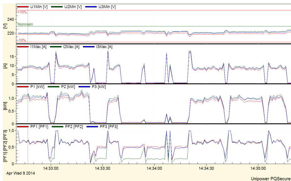
Obrázek 5.26 Nastavený proud zátěže 100 A_22 V, svařování metodou MMA / 20 s
