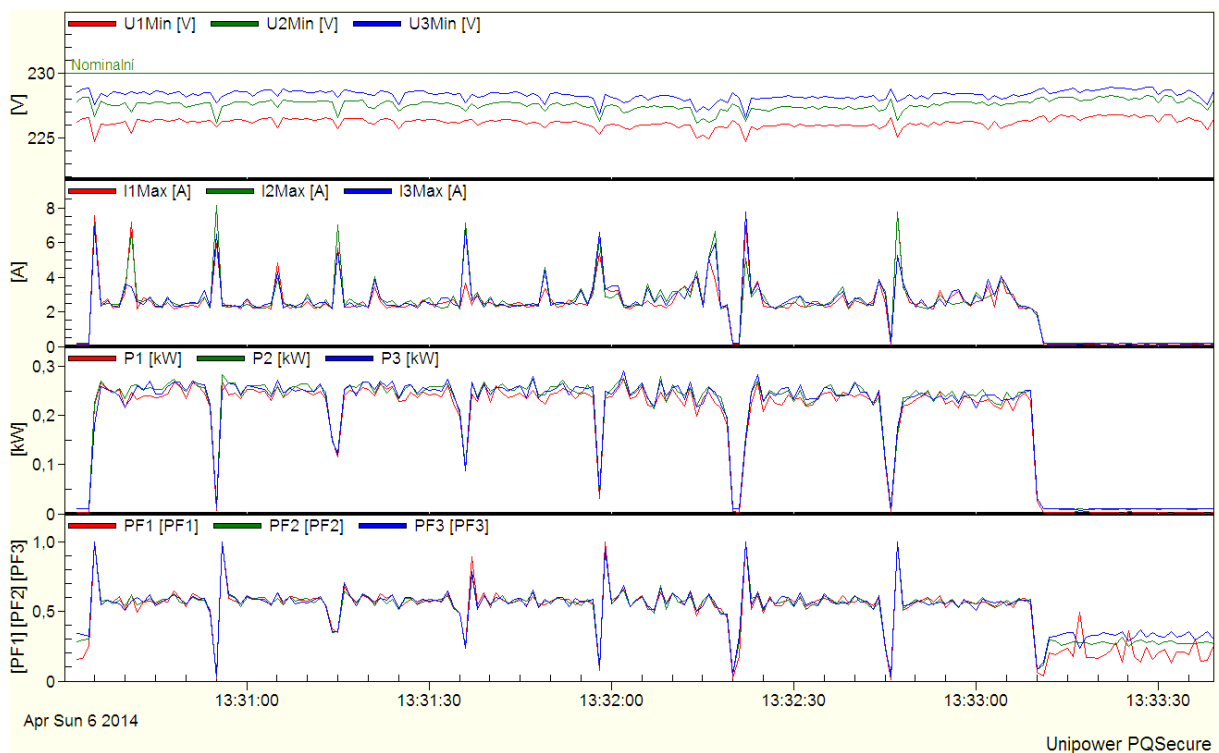
Obrázek 5.20 Nastavený proud zátěže 40 A_15.2 V, pravidelné spínání po 20 s
