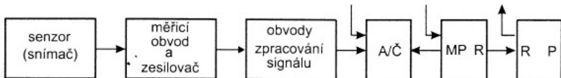
Obrázek 2.1.: Blokové schéma měřicího řetězce se senzorem, A/Č - analogově číslicový převodník, MP - mikropočítač, R - rozhraní, P - nadřazený systém[15]
