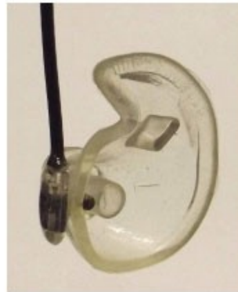
Obr 2.3 – PPG senzor určený k umístění v uchu pacienta, převzato z [4]
