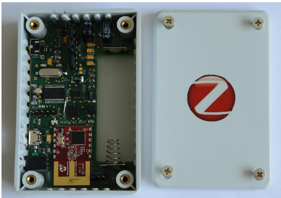
Obrázek 12.6.1.: Pohled na otevřenou krabičku bezdrátového teplotního senzoru shora
