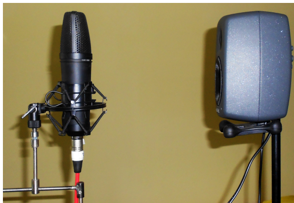
Obrázek 7.2. Uspořádání mikrofon (Audix CX111)–reprosoustava (Genelec 6010A).
