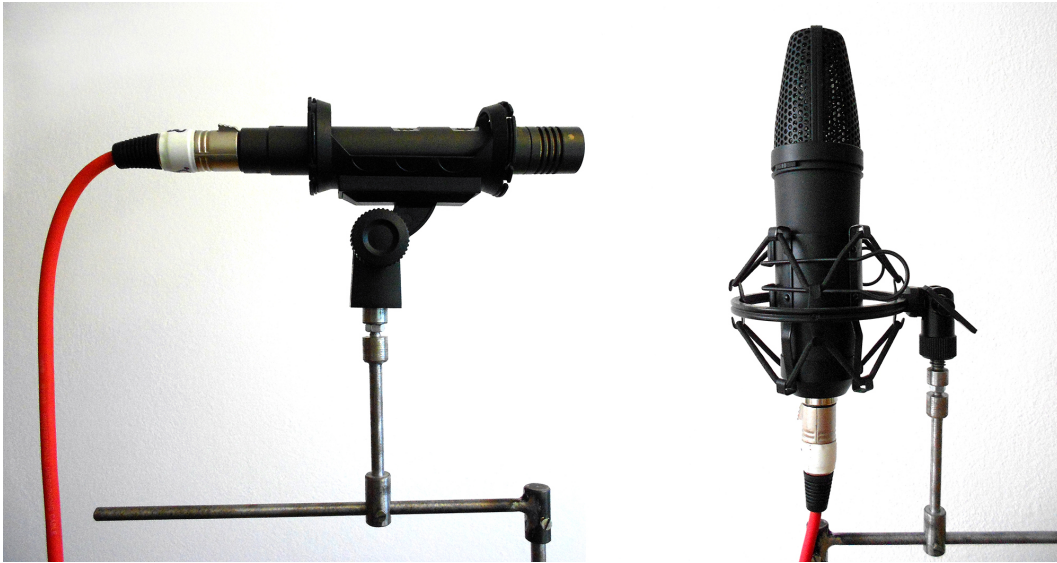
Obrázek 6.1. Část měřicího přípravku, sloužící na kompenzaci excentricity membrány vůči uchycení mikrofonu.
