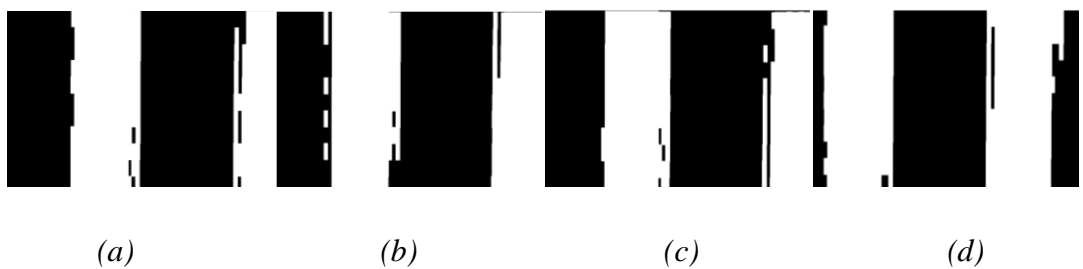
Obr. 13 Snímky rozsvícených jednotlivých subpixelů po průchodu filtrem (a) subpixel 1_1, (b) subpixel 1_10, (c) subpixel 2_5, (d) subpixel 19_14
